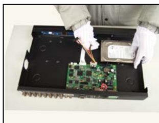
5. Nainstalujte napájecí kabely SATA
